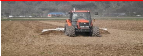
レベラーによる均平作業
