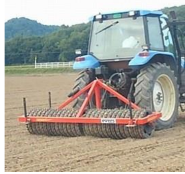
は種前鎮圧施工の様子
