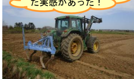
カットブレーカーの施工（ホクレンのデモ機を使用）
