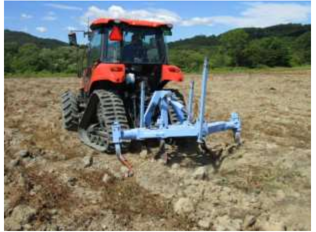
カットブレーカー
