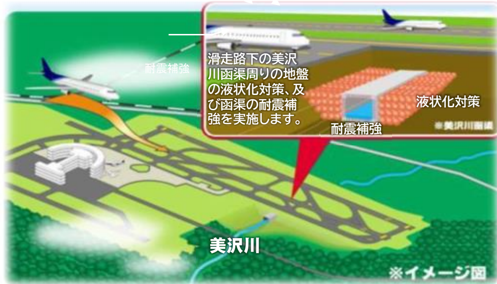
【新千歳空港施設 美沢川函渠の耐震対策】
