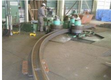
円錐の曲げ加工とトンネル支保工(阿部鋼材株式会社ホームページより引用)
