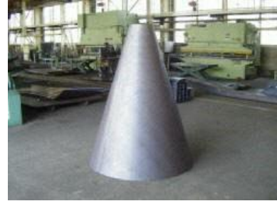
円錐の曲げ加工とトンネル支保工(阿部鋼材株式会社ホームページより引用)
