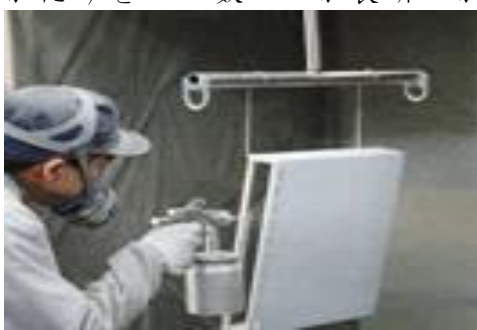
塗装と曲げ工程の様子 (株式会社中央ネームプレート製作所ホームページより引用)
