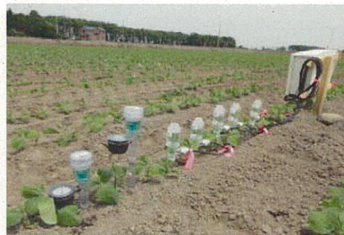
地下かんがいモデルほ場における 土壌水分量と地下水位の測定状況
